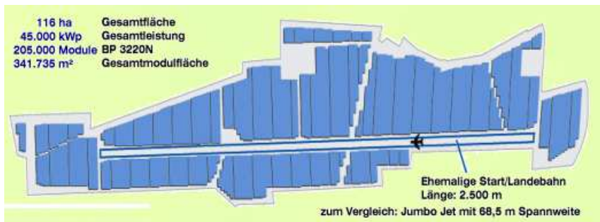
Photovoltaikanlage Köthen - 45 MWp - derzeit größte Stringwechselrichteranlage der Welt
